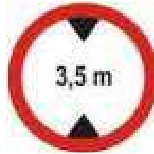
Larangan Masuk Bagi Kendaraan Dengan Tinggi Lebih Dari .....Meter
